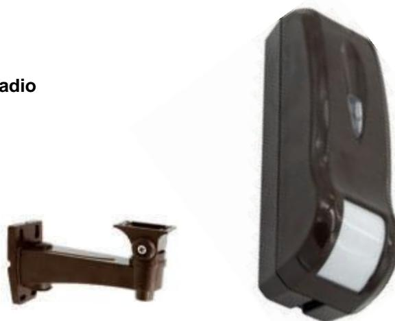
Sensori doppia tecnologia radio a tenda bidirezionale di piccole dimensioni ideali per la protezione di corridoi. I sensori creano una copertura a tenda con un angolo di 7.5° ed una portata regolabile fino a 12 mt. La scheda elettronica viene, inoltre, sottoposta ad un processo di tropicalizzazione per assicurarne un corretto funzionamento in ogni condizione di umidità e temperatura. accurata progettazione rendono questi sensori particolarmente stabili ed immuni ai falsi allarmi.
