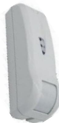
Sensore infrarossi passivi radio a tenda monodirezionale di piccole dimensioni ideali per la protezione di corridoi. I sensori creano una copertura a tenda con un angolo di 7.5° ed una portata regolabile fino a 12 mt. La scheda elettronica viene, inoltre, sottoposta ad un processo di tropicalizzazione per assicurarne un corretto funzionamento in ogni condizione di umidità e temperatura. L'accurata progettazione rendono questi sensori particolarmente stabili ed immuni ai falsi allarmi.
