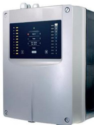
E' un sistema attivo a 1 tubo per la rivelazione di fumo ad aspirazione, con indicatore di concentrazione del fumo. Risulta particolarmente indicato per la rivelazione incendi in quelle situazioni dove la rivelazione di tipo puntiforme non è adatta a causa di condizioni ambientali (temperatura, polvere) o per vincoli funzionali (difficoltà di manutenzione, presenza di controsoffitti...).
