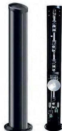
Coppia di barriera a doppia tecnologia composta da 2 colonne con ottiche IR TX ed un TX Microonda 24 GHz in una, mentre nell'altra vi sono ottiche RX e RX Microonda 24 GHz.
