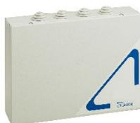
Unità periferica da collegare alla CE 700, dotata di 8 ingressi per trasmettitori con segnale 4-20 mA. L'unità è completa di: " Custodia " Scheda 8 ingressi " Scheda alimentazione " Scheda comunicazione RS485 " Predisposto per una batteria 12V. 3Ah . Grado di protezione IP65. Dimensioni: 290x220x80 Rilevatori gas rilevati 4-20mA
