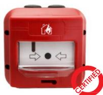
PULSANTE MANUALE RIPRISTINABILE INDIRIZZATO CON SCHERMO DI PROTEZIONE IP67 - Pulsante manuale, progettato e realizzati secondo Norma EN54-11, Schermo trasparente di protezione per evitare attivazioni accidentali. Fornito di chiave di ripristino. Installazione da parete. IP67. 112 x 112 x 82 mm
