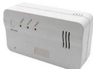
Rilevatore di gas **PROPANO** Standard EN50194. Il microprocessore integrato garantisce un monitoraggio continuo e accurato delle fughe di gas. Sensore a semiconduttore FIGARO utilizzato per il rilevamento delle perdite di gas. Uscita relè. Forte segnale di allarme. Pulsante Test. **Alimentazione 12V ( NB920DNR) 220V ( NB920ALR) Ideale per Camper e Motorhome**
