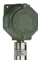
Sensore per gas infiammabili **Benzina** Sono gas più pesanti dell'aria. Il rivelatore va posto a 30 cm dal pavimento, a una distanza max. di 1-1,5 metri dall'utilizzatore, lontano da angoli del locale o prese di ventilazione **ATEX**
