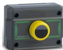
Rilevatore con un sensore a cella elettrochimica per gas **Monossido di carbonio (CO)**, utilizzato in sistemi per parcheggi, centrali termiche e ambienti da proteggere dalla possibile presenza di CO. (non è adatto per ambienti industriali). **IP44**
