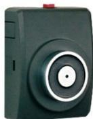
Fermo magnetico indirizzato con collegamento su loop . Dotato di 3 LED di stato. Il LED verde lampeggia ogni volta che il dispositivo viene interrogato dalla centrale. Il LED rosso acceso indica che è stato attivato lo sblocco della porta. Si spegne al reset centrale. Il LED giallo segnala un guasto nel modulo. Collegamento massimo di 20 fermi su ogni loop. Assorbimento a riposo: 800 µA – assorbimento in allarme: 60 mA. Grado di protezione: IP21. Dimensioni: 112 x 84 x 47mm
