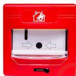
PULSANTE MANUALE RIPRISTINABILE Progettato e realizzato secondo Norma EN54-11, Schermo trasparente di protezione per evitare attivazioni accidentali. Fornito di chiave di ripristino. Installazione da parete.
