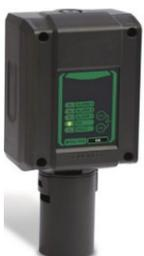
Sensore di tipo catalitico per gas infiammabili **GPL**, è un gas più pesante dell'aria. Il rivelatore va posto a 30 cm dal pavimento, a una distanza max. di 1-1,5 metri dall'utilizzatore, lontano dagli angoli del locale. **IP65**
