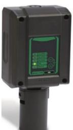
Sensore di tipo catalitico tarato per rilevare **Idrogeno**, un gas incolore, inodore, altamente infiammabile molto più leggero dell'aria. La sua densità relativa all'aria è 0,07 ed il suo LIE è 4%v/v (espresso in %Volume). **IP65**
