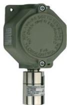
Sensore per gas infiammabili in grado di rilevare **GPL**, è un gas più pesante dell'aria. Il rivelatore va posto a 30 cm dal pavimento, a una distanza max. di 1-1,5 metri dall'utilizzatore. **ATEX**
