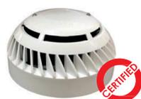
RILEVATORE MULTICRITERIO CONVENZIONALE - Il rivelatore multicriterio è un sensore che attraverso una analisi sia della variazione di temperatura sia della quantità di fumo permette una tempestiva rivelazione dell'allarme grazie all'analisi dei due parametri contemporaneamente. Caratteristiche principali: Doppio led di visualizzazione 360° Design basso profilo. Completo di base.
