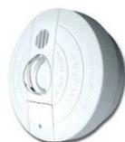
**Rilevatore autonomo di calore** Rilevamento (57 °C)+ termovelocimetrico incrementi superiori a 6,7°C minuto Alimentazione 220Vac+Pila 9Volt per backup (esclusa). Autonomia 30 mesi con batteria alcalina Avviso acustico con buzzer: 85 dB Segnalazione batteria bassa Dimensioni:112x64x43,5mm **Certificazione CE.**
