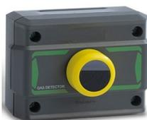
Rilevatore con un sensore di tipo catalitico per gas infiammabili **GPL**, è un gas più pesante dell'aria. Il rivelatore va posto a 30 cm dal pavimento, a una distanza max. di 1-1,5 metri dall'utilizzatore, **IP44**
