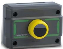
Rilevatore con un sensore di tipo catalitico tarato per rivelare **Metano**, un gas combustibile più leggero dell'aria. La sua densità relativa all'aria è 0,55 e il suo LIE è 4,4%v/v (espresso in %Volume). **IP44**
