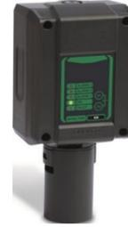
Rilevatore con un trasmettitore 4÷20mA di **Ossigeno** con sensore a cella elettrochimica, utilizzato in sistemi centralizzati d'allarme per laboratori, industrie e ambienti da proteggere dalla possibile assenza o eccesso di O2 o presenza di gas inerti. **IP65**
