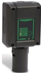
Sensore di tipo catalitico per gas infiammabili **Benzina** Sono gas più pesanti dell'aria. Il rivelatore va posto a 30 cm dal pavimento, a una distanza max. di 1-1,5 metri dall'utilizzatore, lontano da angoli del locale o prese di ventilazione **IP65**
