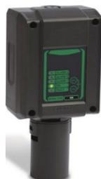
Sensore tarato per rivelare **Metano**, un gas combustibile più leggero dell'aria. La sua densità relativa all'aria è 0,55 e il suo LIE è 4,4%v/v (espresso in %Volume). **IP65**
