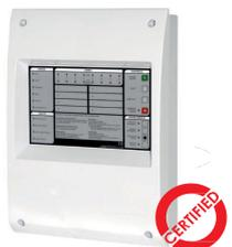
CENTRALE ANTINCENDIO 8 ZONE CONVENZIONALE - Centrale a 8 zone convenzionali (fino a 256 dispositivi) non espandibili. Collegamento max 32 rivelatori per zona a variazione di impedenza. Zone non programmabili. Tempo di ritardo programmabile per zona max 10 minuti. Uscita 24 Volt supervisionata. 2 uscite circuiti sirene monitorate. 2 uscite relè allarme e 1 guasto. Funzione notte/giorno. 2 livelli di accesso. Conforme EN54-2 e 4. Uscita per pannello ripetitore
