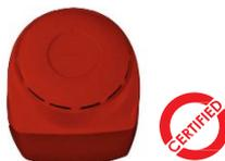
Segnalatore acustico e luminoso lampeggiante convenzionale per sistemi antincendio e antigas. Alimentazione 12-30Vdc. Assorbimento in allarme 80mA @ 24V Pressione sonora 1mt 105dB Frequenza 2.9 ÷ 4.0 kHz Modulazione di frequenza 3.2Hz LED lampeggiante 0.6W Temperatura di lavoro -25°C ÷ +60°C Conforme EN54-3. **Certificazione CPR**
