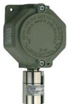
Sensore per gas infiammabili, utilizzato in impianti alimentati a **Metano** (CH<sub>4</sub>), è tarato per rivelare Metano, un gas combustibile più leggero dell'aria. La sua densità relativa all'aria è 0,55 e il suo LIE è 4,4%v/v (espresso in %Volume). **ATEX**
