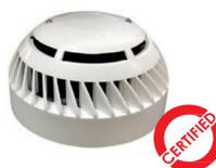
RILEVATORE TERMOVELOCIMETRICO CONVENZIONALE – Il rilevatore termovelocimetrico è un sensore in grado di monitorare la temperatura di un ambiente segnalando il superamento di una soglia prefissata o il rapido aumento della stessa. Visualizzazione 360°. Design basso profilo. Completo di base.
