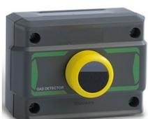
Rilevatore con un sensore di tipo catalitico per gas infiammabili **Benzina** Sono gas più pesanti dell'aria. Il rivelatore va posto a 30 cm dal pavimento, a una distanza max. di 1-1,5 metri dall'utilizzatore, **IP44**
