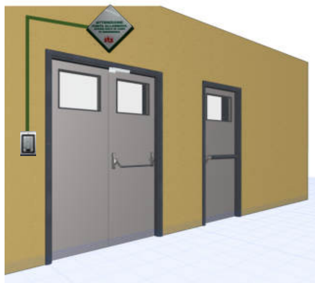
Esempio installazione NB: Abbinare almeno 1 tastiera o interruttore a chiave
