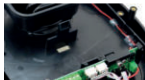
Alloggiamento per batteria 12 V 2,1Ah
